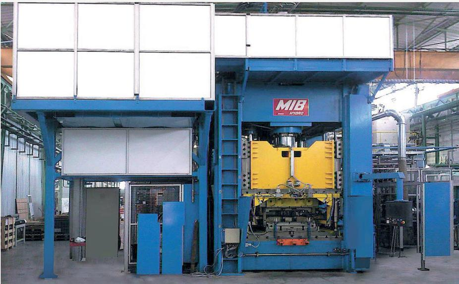
Cette presse hydraulique de 1000 tonnes est destinée à travailler un tube par le biais d'un outillage multipostes.
